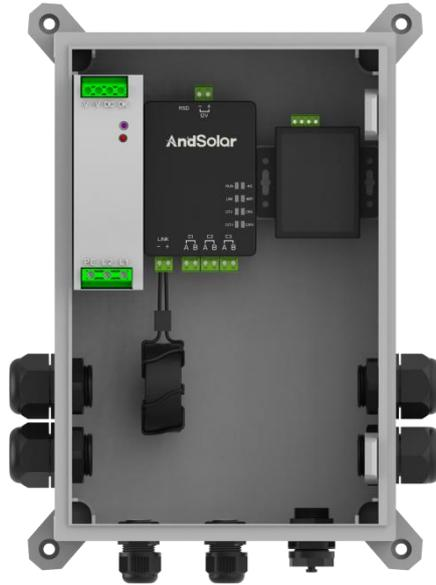
集中器ADCU套件与组件智能关断器AMCL配合使用。电源通电时,通过ADCU对AMCL进行控制或监控,光伏组件接入AMCL。电源断开时,ADCU关断,AMCL自动关断,组件断开与直流系统连接,当ADCU恢复工作时,AMCL启动,恢复组件接入。该解决方案符合 NEC 2017&2020(690.12)规范。
